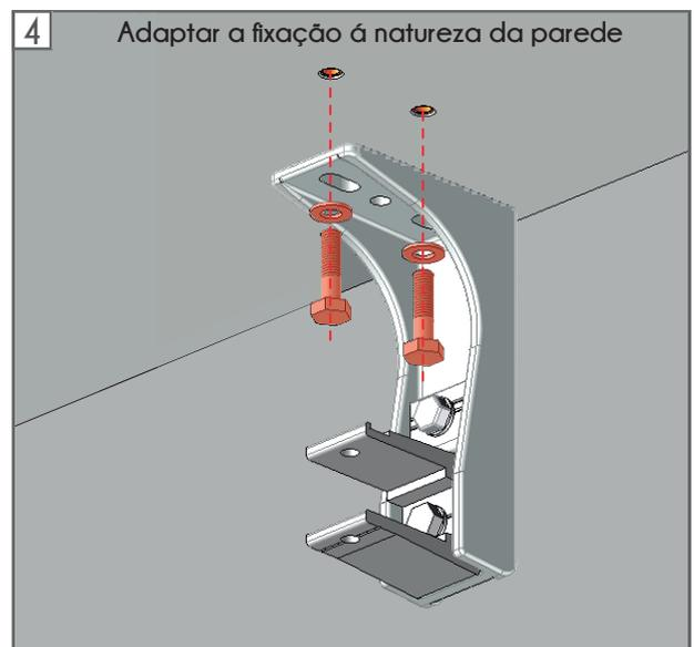
Fixação com parafusos 10mm. Kit de parafusos, cavilhas não facultadas.
